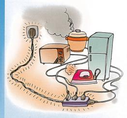
接线板使用时要防止绝缘部分 磨损造成短路打火; 经常移动会使 接线板内部接触松动,造成局部过 热; 不要在同一个接线板上同时使 用多种大功率电器用具。
